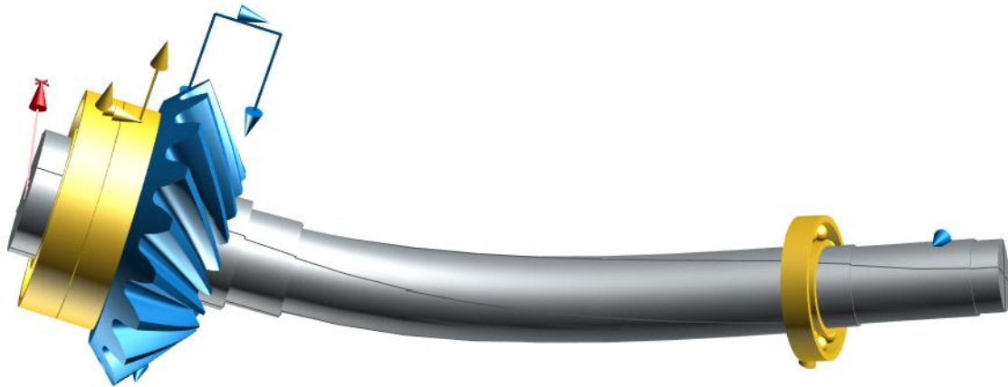
Abbildung 8: Verformung der Abtriebswelle innen
